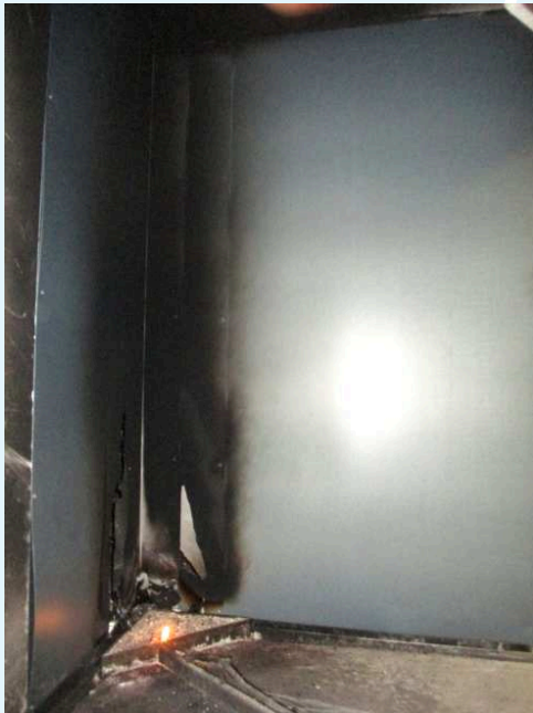
Vista totale della superficie esposta dell'ala lunga dopo la prova.
