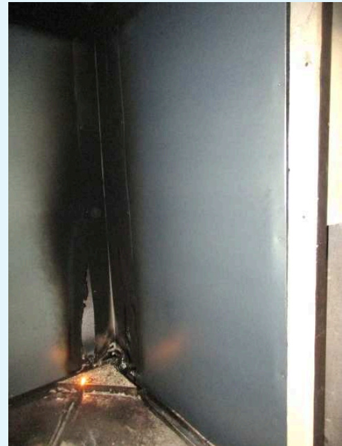
Vista totale del bordo esterno verticale dell'ala lunga dopo la prova.
